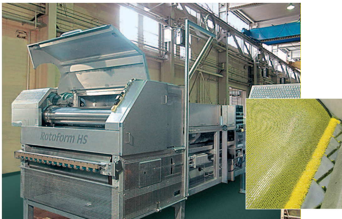
Rotoform HS – подача капель серы на стальную ленту конвейера-охладителя
