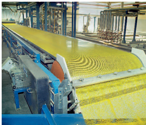
Установка Rotoform – разгрузочный узел
