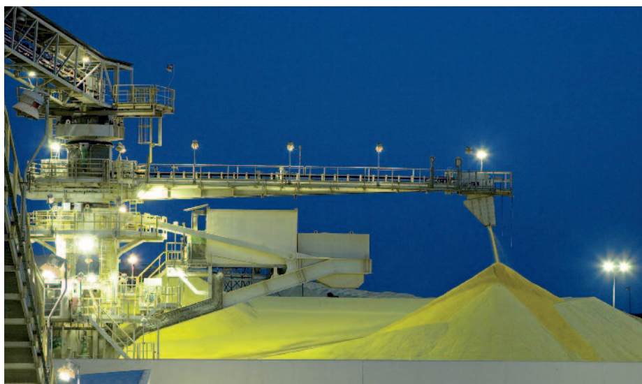
Снимок завода Бапко по производству серы в Бахрейне в ночное время. Полностью оснащенный завод на базе 4 установок гранулирования с высокой скоростью гранулирования (RF high speed)
